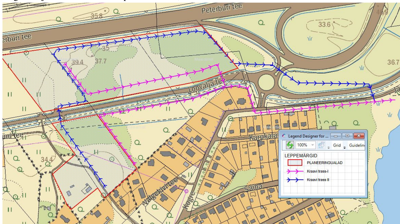
Joonis 1 Sademevee ärajuhimise kraavitrasside variandid
